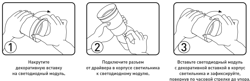
Рис. 2. Сборка светильника
